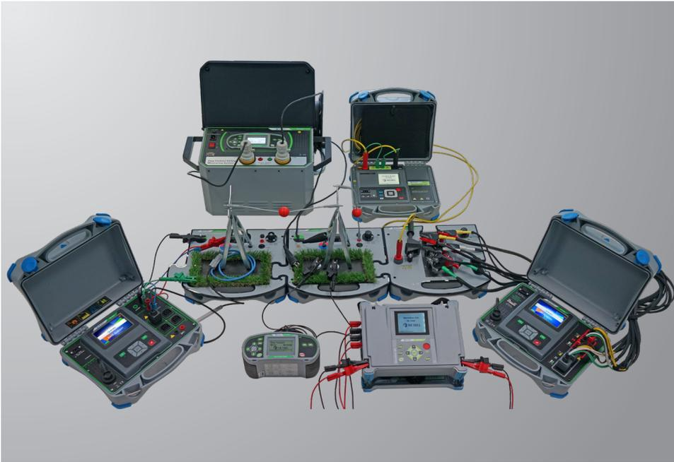
Der MI 3298 Power Network-Anwendungstrainer (MI 3298 P1 und MI 3298 T) basiert auf einem "Puzzle"-Konzept zur Simulation und zum Training verschiedener Messsituationen im Hochspannungsumfeld. Es kann als eigenständiges Trainingsmodul oder mit beliebig vielen miteinander verbundenen Trainingsmodulen verwendet werden. Die Trainingsmodule sind für Demonstrationen, Schulungen und Ausbildungszwecke konzipiert.
